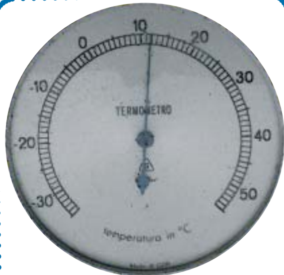
IL TERMOMETRO MISURA LA TEMPERATURA DELL'ARIA IN GRADI. QUI VEDETE UN TERMOMETRO CHE SFRTTA LA DILATAZIONE DEI METALLI PER MUOVERE LA LANCETTA
